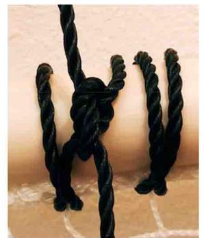
3.片方のロープで輪を作り、もう一方のロープを通し 三度巻きつけます
